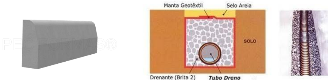
Imagem 04: meio fio pré-moldado e tubulação flexível perfurada PEAD;
